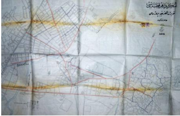
Şekil 17. Eskişehir Kasabası Tenvîrât-ı Elektrikiye Projesi Hatt-ı Havâ'i Teşkilâtı (Elektrikle Aydınlatma Projesi- Havai Hat Kurulumu ) (Arslan, 2014, Ek-23)
