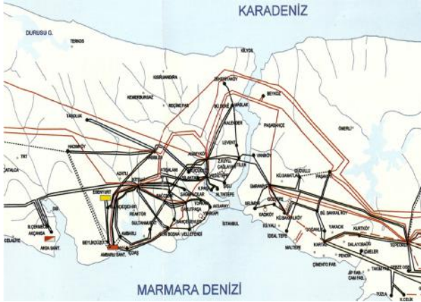
Şekil 12. 154 ve 380 kV Boğaz atlamaları ve bağlantı hatları
