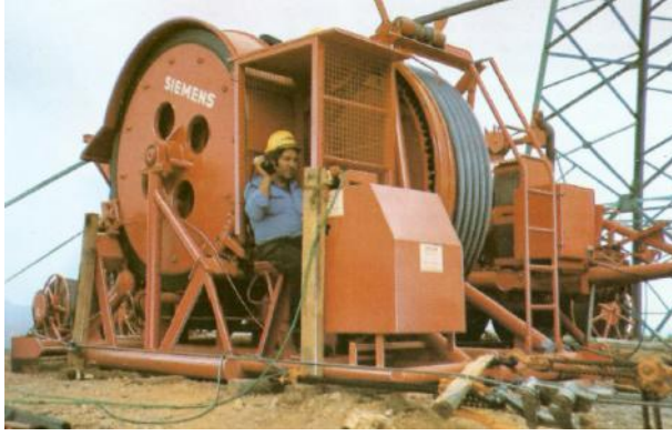
Şekil 11. 180 kN (18 ton) boğa teker çekme makinesi (tensioner)
