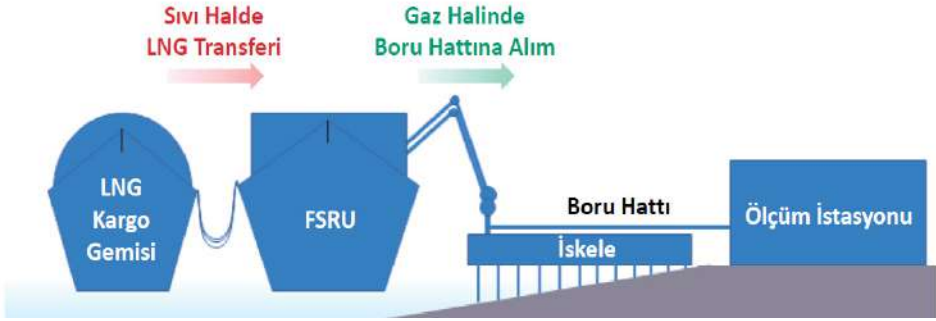
Şekil 23: FSRU terminalinde LNG transferi 201
