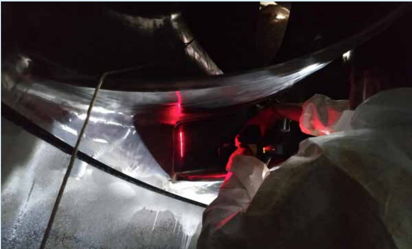
Şekil 3: Türbin Çark Kanadının Lazer Taranması
