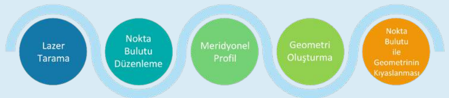
Şekil 1: Türbin Çarkı Tersine Mühendislik Prosedürü
