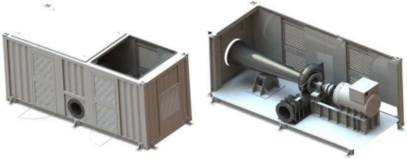
Şekil 5 Konteyner HES Genel Yapısı
