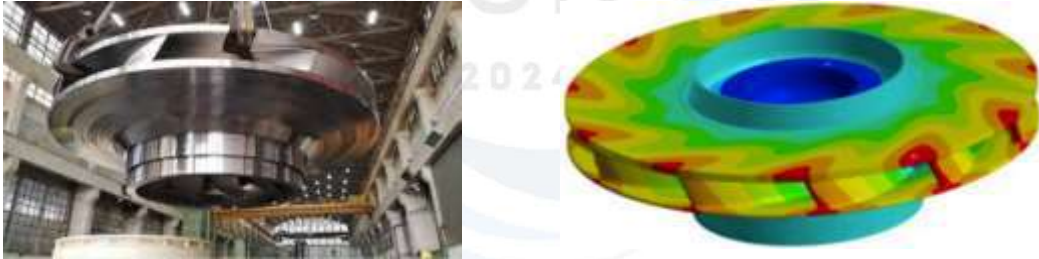
Şekil 2 Türbin tasarımında gelişmiş esneklik sağlayan CFD optimizasyonu
